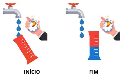
Figura 3: Exemplo de medição de vazão utilizando proveta e cronômetro.
